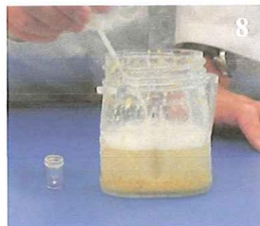
Deje la muestra en “reposo” aproximadamente 15-20 segundos. Utilizando una pipeta nueva, llene un tubo de muestreo nuevo como se muestra arriba. Evite material particulado (use la parte mas clara o translúcida del extracto).
